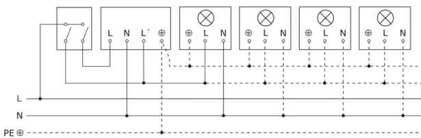
Schaltplan Anschluss 4-fach Tasterkoppler an DALI2 APC
